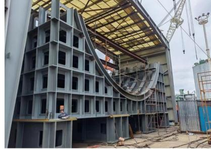
严把质量关,从开始时原料请购、入厂检验、预处理到下料、理料,再到开坡口、拼板、焊 接及无损检测,从小件车间小组,到重装车间中组,再到码头大型拼装场地总组合拢。
