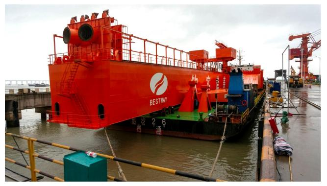
"东沙 26"是东沙船务(江苏)有限公司的第一艘重大件货物运输船。总长度87.9米。 型宽 21.8 米. 最大载重量 5050 吨。本次装载的货物是由江苏格雷特起重机械有限公司制造
